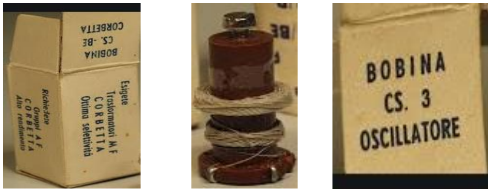
Figura 3, il contenitore, la bobina CORBETTA CS.3/BE, particolare della scatola.
