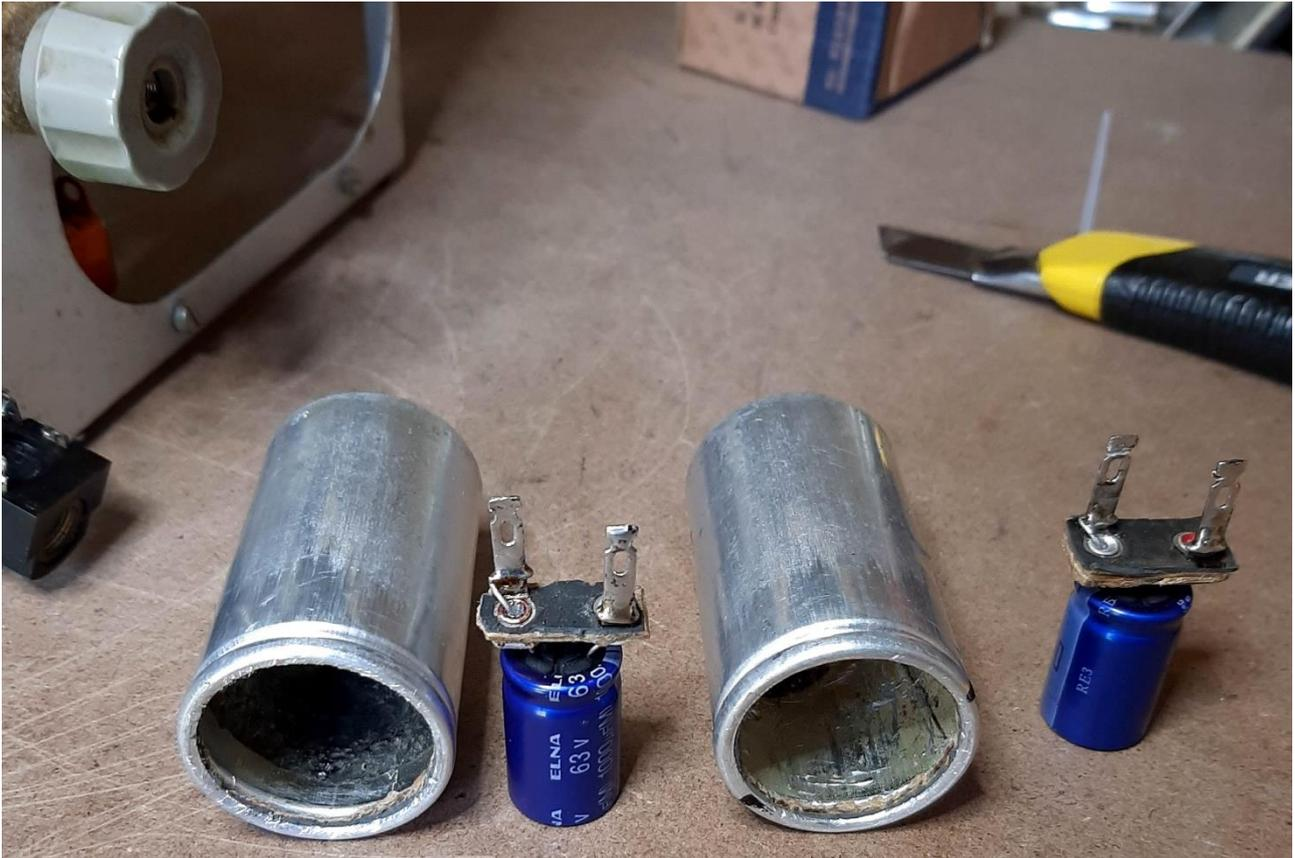
Figura 15, ricostruzione degli elettrolitici
