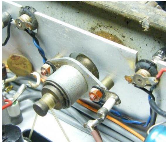
Figura 14, meccanismo della demoltiplica
