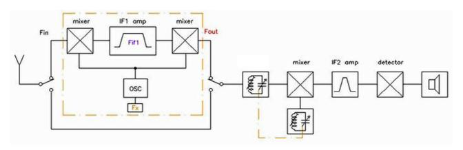
Usando un quarzo da 3 MHz per esempio (Fx), la tripla conversione che ne deriva permette di traslare i 200 KHz dei 40 metri sul tratto di scala che va da 1 a 1.2 MHz. È un miglioramento notevole, e se si pensa che la prima media frequenza è a 4 (da 4 a 4.2) MHz la frequenza immagine è a 1 MHz, ben lontana da 7.
