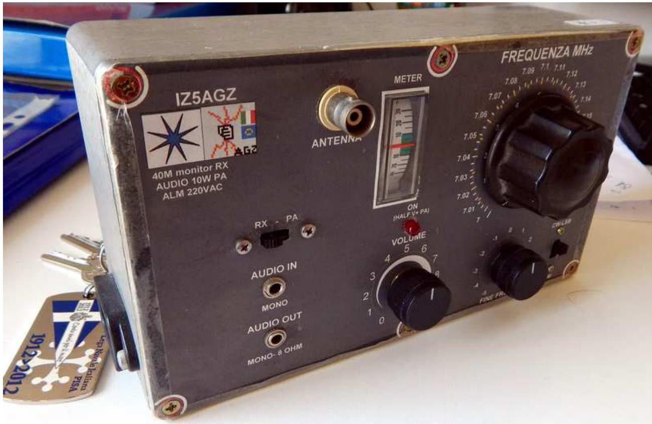
Ho utilizzato un modulo in commercio impiegante il circuito integrato TDA1072A e sintonia a diodi varicap. A questo sono state apportate lievi modifiche per utilizzare al meglio la sintonia varicap, l'uso dello S-Meter e una porzione di media frequenza esterna con BFO e rivelatore a prodotto per la ricezione SSB e CW. Il modulo MK2745 di produzione italiana è stato acquistato come ultimo pezzo in quanto non più in produzione da tempo.
