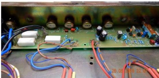
Inoltre il collettore del pnp in origine si collegava dalla saldatura sul circuito stampato alla sbarra del -22 Volt (a vuoto -33) tramite un ponticello di filo tagliato e stagnato (forse per la misura della corrente del finale). Io ho saltato questo possibile punto di caduta tensione andando direttamente alla barra del -22.
