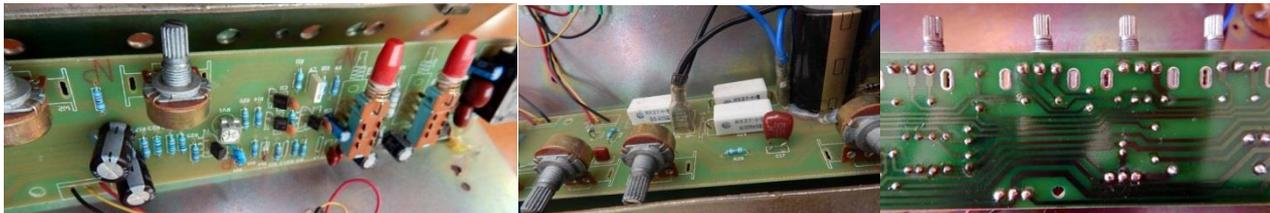
Questo fatto è inoltre indice che il 1N4007 sia scarso come prestazioni per questo circuito. Ci sono due condensatori di filtro da 6.8 milliFarad. Quindi ho sostituito il ponte con uno più grande, da alimentatore switching, avvitato allo chassis per dissipare eventuale calore.
