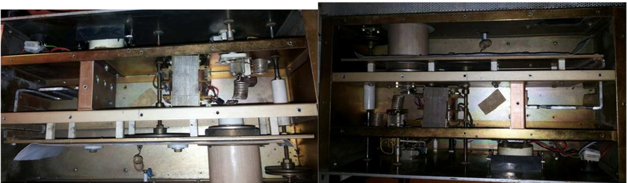
Due parole sul lineare: in origine era per la banda broadcast FM 100 MHz, poi portato a 50 fresando ai bordi la linea di sintonia in modo da renderla più lunga. I condensatori di accordo e di accoppiamento sono dei dischi su vite che si allontanano e si avvicinano alla linea di accordo (e all'uscita). La placca della finale è accoppiata alla linea con una piastra parallela isolata da un foglio di teflon. La linea e i condensatori di accordo formano un circuito parallelo classico.
