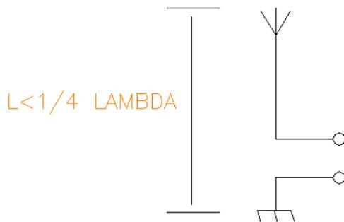
Per utilizzarla proficuamente in ricezione necessita di un accordo, altrimenti è sorda. La banda preferita è 40 metri, quindi ho eseguito una misura con il minivna su frequenze da 7000 a 7200.
