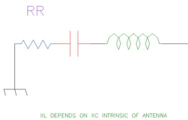
Un modo per aumentare la selettività dell'antenna stessa è quello di inserire una capacità serie, che aumenta la reattanza della componente capacitiva e richiede infine una reattanza induttiva più grande per la sintonia.
