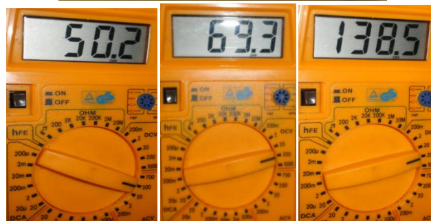
Tensione alternata tensione continua D1-C1 tensione continua D2-C2
