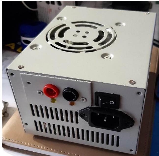
La tensione è di 12Volt nominali. Per questo scopo ho scelto una batteria piombo gel sigillata da 1.2 A/h. Normalmente le tensioni di alimentazione per i miei lavori di RF sono inferiori a 12V, quindi facilmente regolabili partendo dal 12V.
