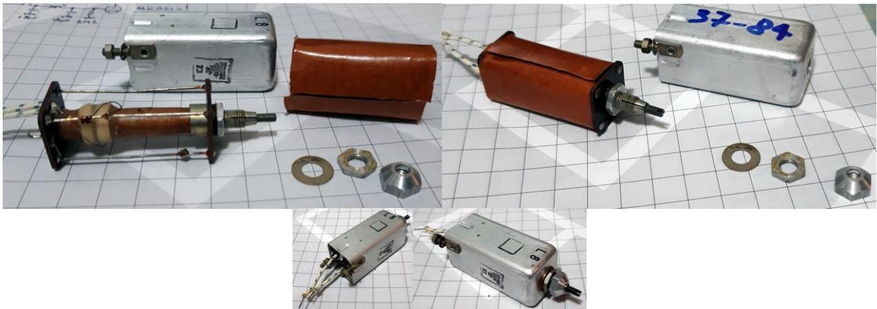
Pur essendo di cartone trovo che sia un ottima bobina. Il nucleo si regola a vite e un dado conico blocca la taratura per evitare spostamenti casuali.
