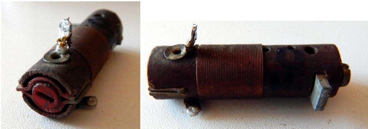
Notare il modo per tenere il nucleo, con due pezzetti di cartone sagomati opportunamente e incastrati in due fessure sul bordo bobina.
