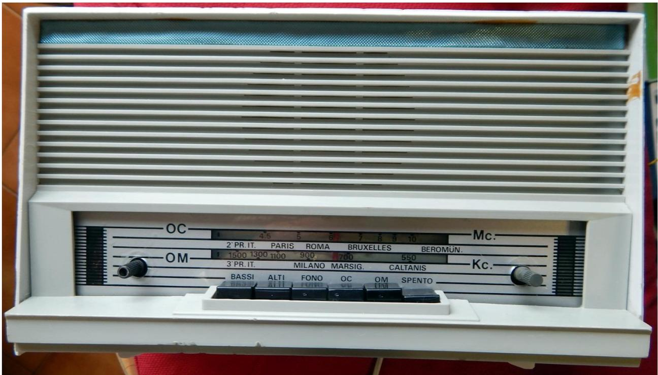
Una volta acceso, (tramite un trasformatore di isolamento, perché monta un autotrasformatore ed ha una fase al telaio) funziona bene anche se in corte andrebbe verificato con più attenzione.
