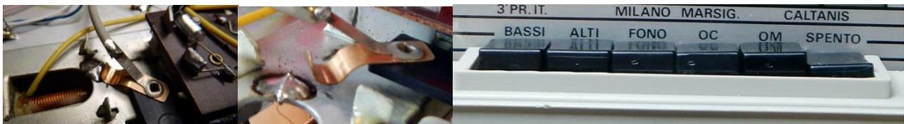
L'anodica deriva dalla presa a 125 Vac, che con il mio trasformatore di isolamento è misurata 122 Vac rms. Sul catodo V1 trovo 122 Vdc. Il valore era uguale anche prima della sostituzione del condensatore elettrolitico di filtro. In origine era un 32+32 uF, ora è un 200uF seguito dopo la resistenza da 1kOhm da un 33uF.
