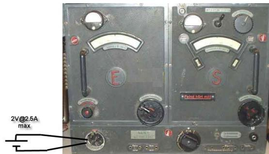
Il consumo totale previsto è di 2.3 Ampere circa al massimo (TX fonìa). La tensione deve stare stabilmente a 2.0 Volt. La potenza al carico,  $2 \times 2.5 = 5$  Watt.
