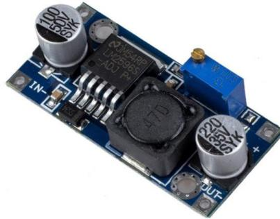
Lo schema elettrico di questi moduli ricalca esattamente lo schema indicato dalle case produttrici del circuito integrato LM2596.
