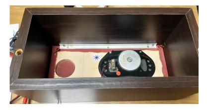
Si vede il modo di fissaggio del pannello al frame, con due profilati di alluminio angolari. L'area vicino al foro tondo poi è stata separata da quella con altoparlante da un diaframma di compensato anch'esso, con un minimo passaggio.
