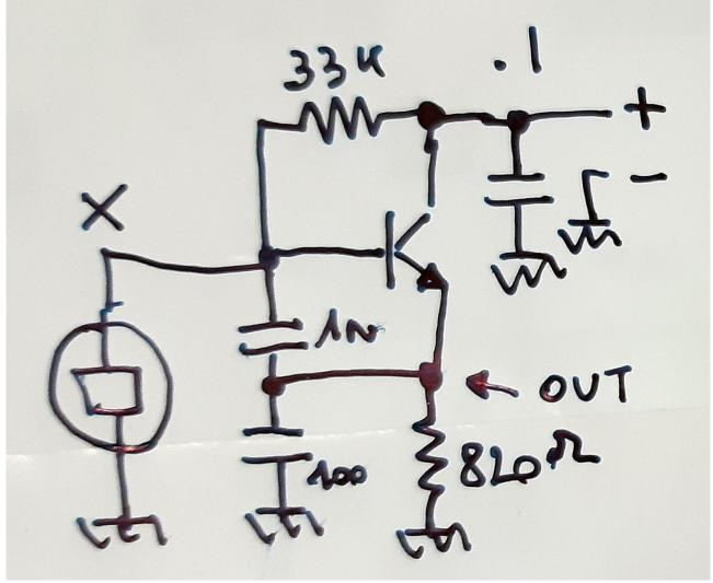
La frequenza del quarzo che ho provato è di 5892.5 kHz.
