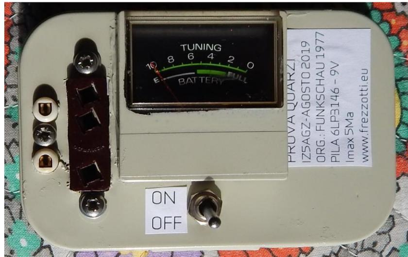
Si tratta di un oscillatore seguito da un rettificatore ed uno strumento, galvanometro, il tutto per avere un oggetto pratico da utilizzare nell'immediatezza quando si voglia valutare se un cristallo va o non va.
