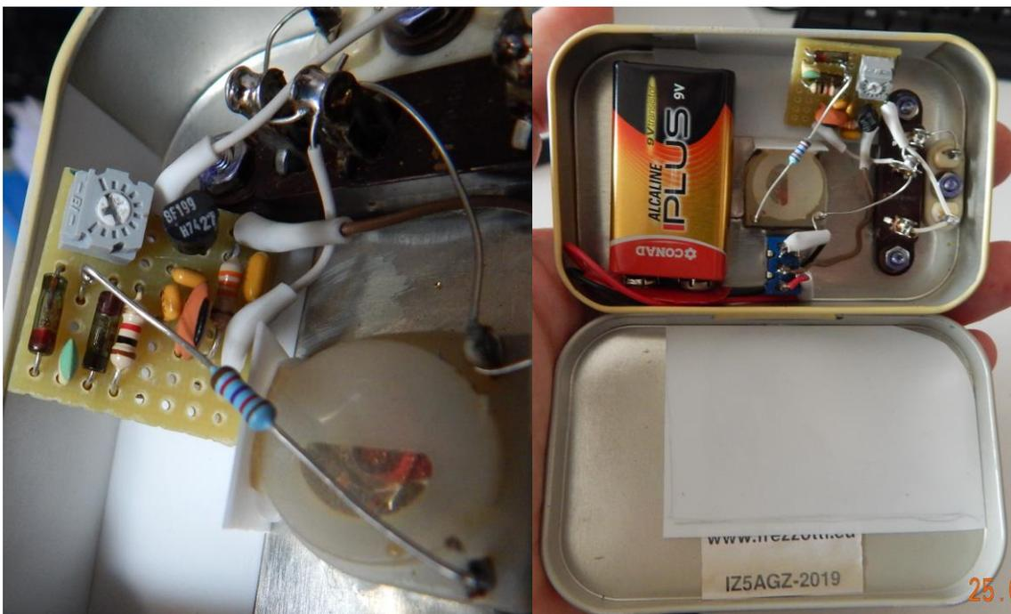
Il circuito è stato messo assieme su di un pezzetto di vetronite millefori.
