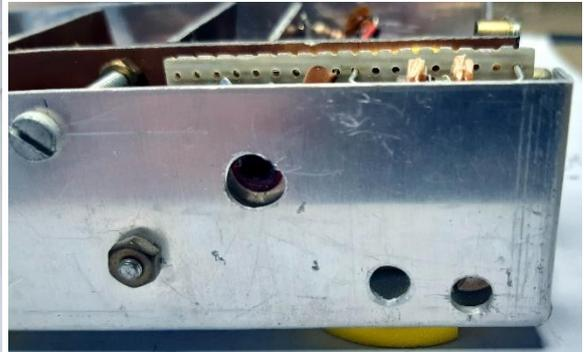
Figura 3, connettore di alimentazione e punti di taratura
