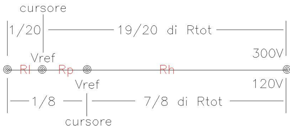
Figura 14, rapporti di resistenza nel partitore
