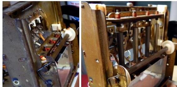
Sopra il circuito con Ls e Lp, al centro l'induttanza in posizione LM, a destra in posizione Lm.
