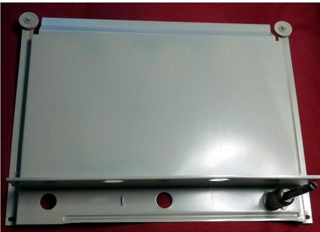
Sopra: il pannello frontale della scala parlante, dopo lavaggio, sverniciatura e verniciatura.
