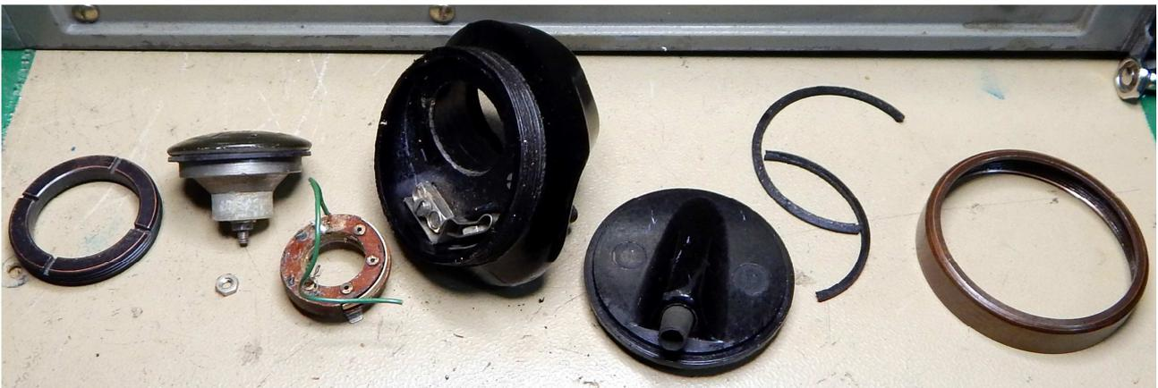
Eccolo smontato, dopo decenni di riposo la ghiera di rame posteriore si era "imparentata" con il corpo di bakelite e l'anello di gomma. C'è voluto un po' d'olio al silicone e il tempo, qualche giorno, per che si ammorbidisse permettendo di svitare la ghiera.
